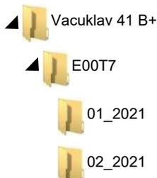
Автоклав проверяет запоминающее устройство для всех видов вывода протоколов (немедленный вывод после выполнения цикла или перенос нескольких протоколов сразу) и автоматически создает каталог для устройства и протоколов за месяц, если таковые отсутствуют. Если протоколы несколько раз выводятся на одно и то же запоминающее устройство, то в расположенном на нем каталоге устройства создается каталог с наименованием «Повторно».
